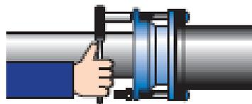
4) Serrare i dadi progressivamente in maniera incrociata fino a che la coppia di serraggio di 67 Nm sia raggiunta.
